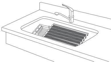
۴ « برای تمیز کردن پوشش شبکه‌ای فیلتر، از دستکش پلاستیکی استفاده کنید تا دستان شما در اثر سایش آسیب نبینند.
