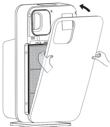
۴ « طبق شکل درب دستگاه را بیندید و جهت ریست کردن هشدار REAPLACE به صفحه ۷ مراجعه کنید.
