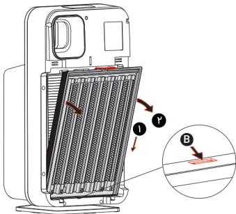
۲ « شبکه فلزی فیلتر الکترواستاتیک را با نگه داشتن لایه پلاستیکی به سمت بالا، از فیلتر جدا کنید.
