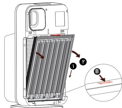
۴ « فیلتر هپا و کربن فعال (کامپکت) با کشیدن زبانه پارچه‌ای بالای فیلتر به سمت خود، از دستگاه جدا می‌شود.
