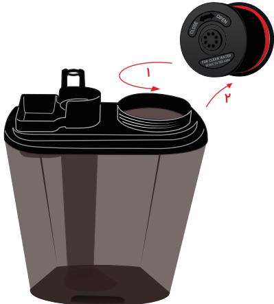
۴ « با دستمال مرطوب و آشسته به ماده تمیز کننده ظروف، داخل مخزن آب را تمیز کنید و با آب بشویید و خشک کنید.
